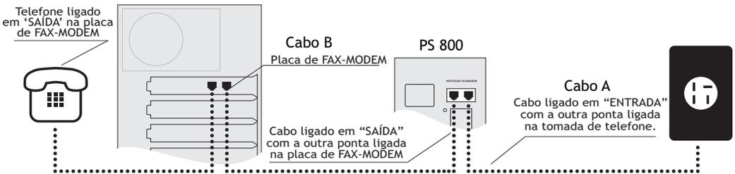
Cabo A: Ligue o plugue na tomada da operadora de telefonia e o conector na tomada de proteção do nobreak (ligar em ENTRADA).
