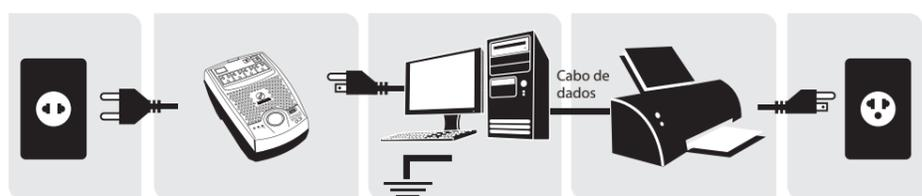
**ERRADO!** Equipamentos tripolares já aterrados e ligados no MIE G3.
